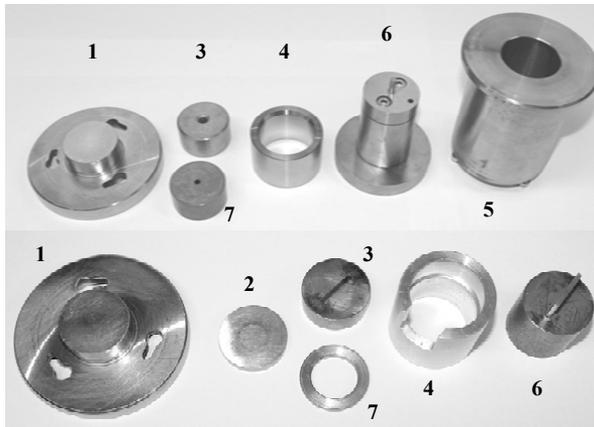
Abb. 15 Presswerkzeuge für das Pressen von zylindrischen Pins mit den Abmessungen  $\varnothing 3 \text{ mm} \times 13 \text{ mm}$  (oben) und von Pins mit quadratischem Querschnitt mit den Abmessungen  $2 \text{ mm} \times 2 \text{ mm} \times 18 \text{ mm}$  (unten). In der Reihenfolge des Einsetzens: 1 – Unterplatte, 2 – Pressplatte, 3 – Füllring, 4 – Hülse, 5 – Stempelführung, 6 – Stempel, 7 – Hilfsvorrichtung zum Auspressen von den in den Füllring gepressten Pin-Proben
