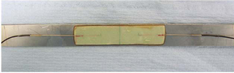
Abb. 54: GFK-Patch mit integriertem FBG-Dehnungssensor, appliziert auf einer Zugprobe.
