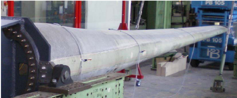
Abb. 61: Gesamtansicht auf das Rotorblatt, das bereits für die Belastungsversuche in einer Prüfvorrichtung eingespannt wurde. Standort: Testlabor der BAM, Abteilung Bauwerkssicherheit.
