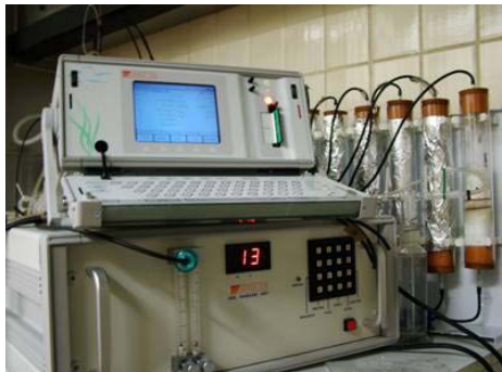
Abbildung 12: Aufbau des Systems zur Bestimmung der Bodenatmung mit einem Infrarotgasanalysator (ADC, Hoddesdon, UK) und den verwendeten Messsäulen.
