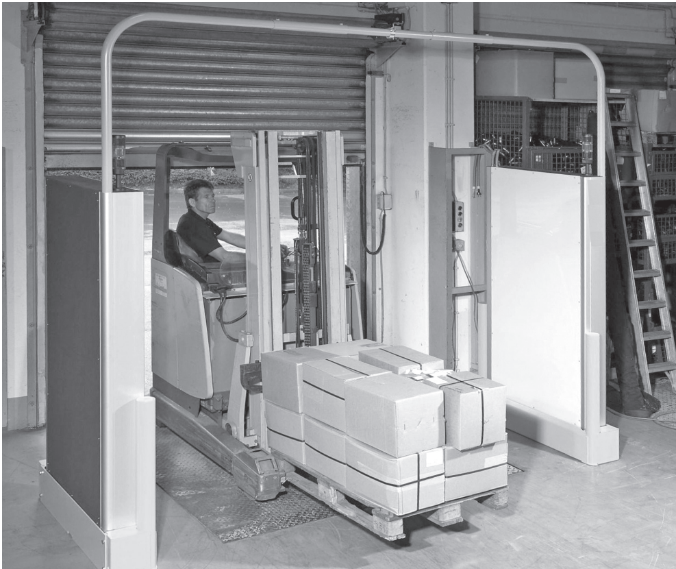
Abb. 6: UHF-Portal im Logistikbereich ©Bühnenbau Schnakenberg GmbH & Co. KG
