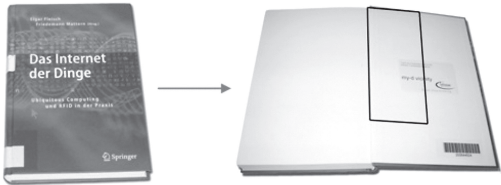
Abb. 6: Positionierung der Transponder (Montage: Kissig)
