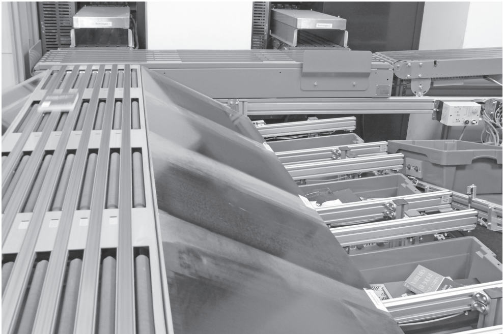
Abb. 2: Die Koppelung von Buchrücknahme, -sortierung und -transport als erster Ansatz eines Logistikkreislaufs
