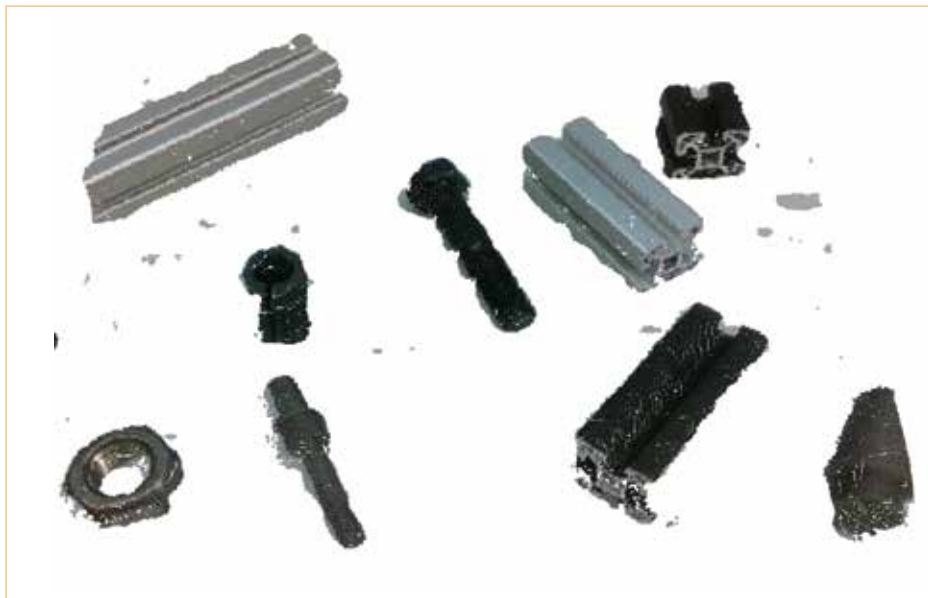
Abbildung 3: Mit einer Tiefenkamera werden Punktwolken von den zu greifenden Bauteilen generiert.
