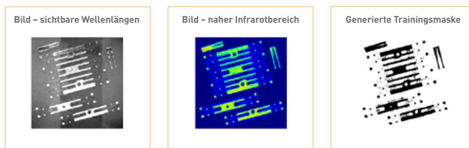
Abbildung 3: Beispielhafte Bilder einer Bauschicht. (links) Kamerabild, (Mitte) Kamerabild naher Infrarotbereich, (rechts) Erzeugte Maske für das automatisierte Labeling
