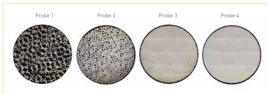
Abbildung 3: Schlißbilder der additiv gefertigten Proben. Das Material ist in grau, die Porenfläche in schwarz dargestellt
