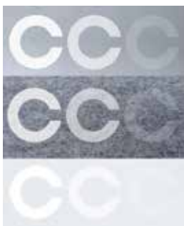
Abbildung 2: Darstellung der Landoltringe auf den verschiedenen genutzten Oberflächen (Aluminium, Beton, Fliese)
