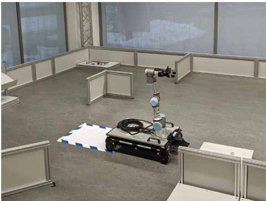
Abbildung 1: Teil der FHWS-RoboCup@Work-Arena, die eine abstrahierte Industrieumgebung darstellt. Der Roboter muss autonom navigieren, statische und bewegte Objekte erkennen sowie greifen, an andere Orte transportieren und wieder ablegen.
