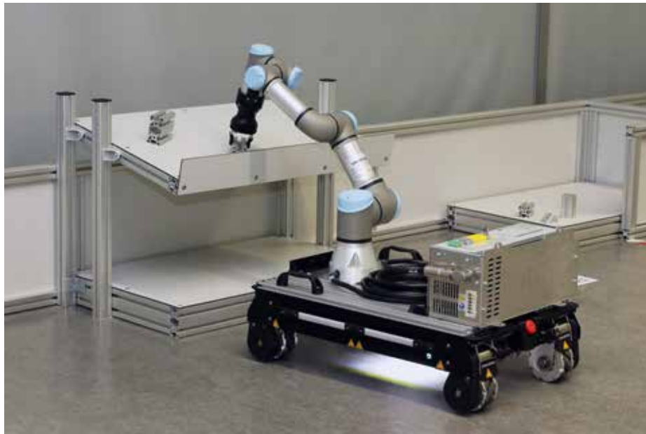
Abbildung 2: Der Roboter führt eine Greifoperation durch. Dazu muss zunächst das Bauteil erkannt, klassifiziert und lokalisiert werden.
