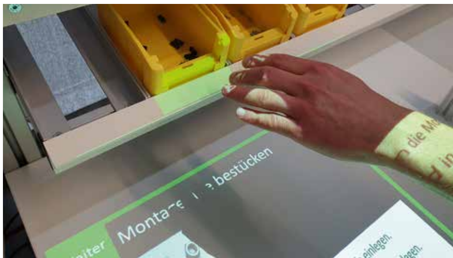
Abbildung 11: Projizierte Montageanweisungen, KLT (Kleinladungsträger)-Erkennung
