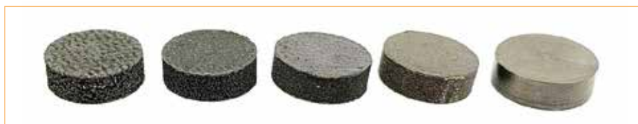
Abbildung 2: Darstellung der additiv hergestellten Proben und der konventionell hergestellten Probe von links nach rechts: Probe 1, Probe 2, Probe 3, Probe 4, konventionelle Probe
