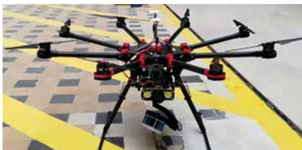
Abbildung 1: Inspektionsdrohne mit Lidar und Kamera
