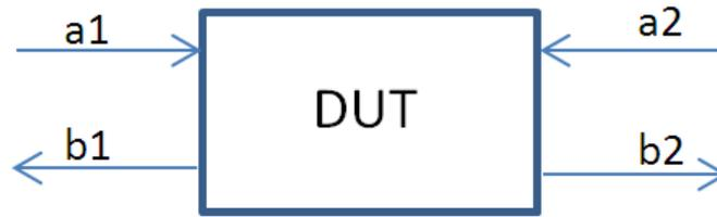
**Abbildung 7-11:** Schema der S-Parametermessung [Kale2 2013].
