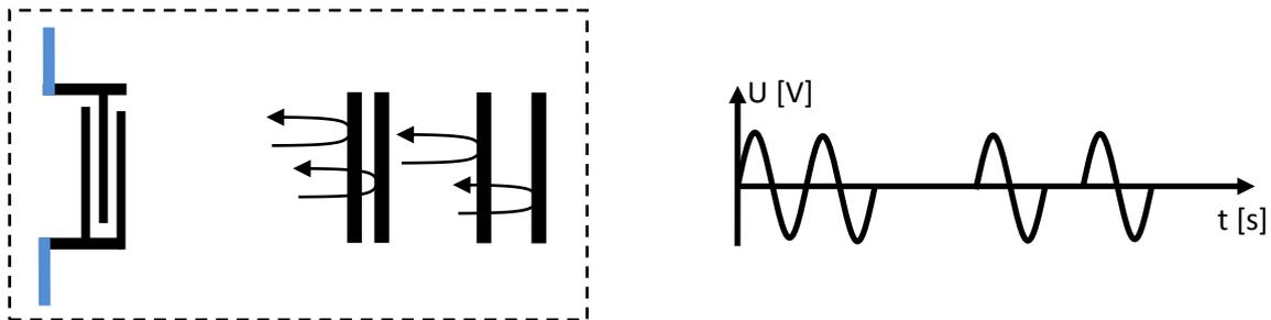
**Abbildung 3-3:** Darstellung eines SAW ID Tags mit der ausgegebenen Signalantwort.
