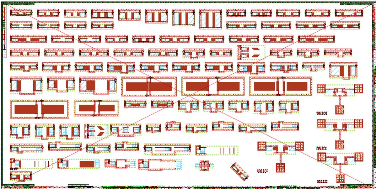
**Abbildung 4-21:** Entwurf von 100 verschiedenen Filtern für Grundlagenuntersuchungen sowie für Anwendungen.
