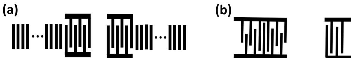
**Abbildung 3-4:** (a) Zwei-Tor Resonator mit 100 bis einigen tausend Reflektor streifen, (b) Bandpassfilter mit einem sinc Fingerüberlapp.
